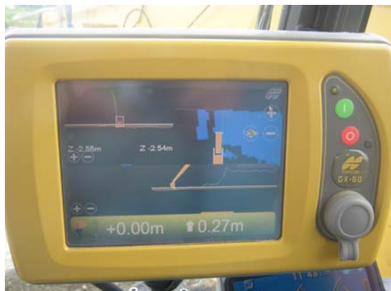
機内モニター画面(掘削時)
